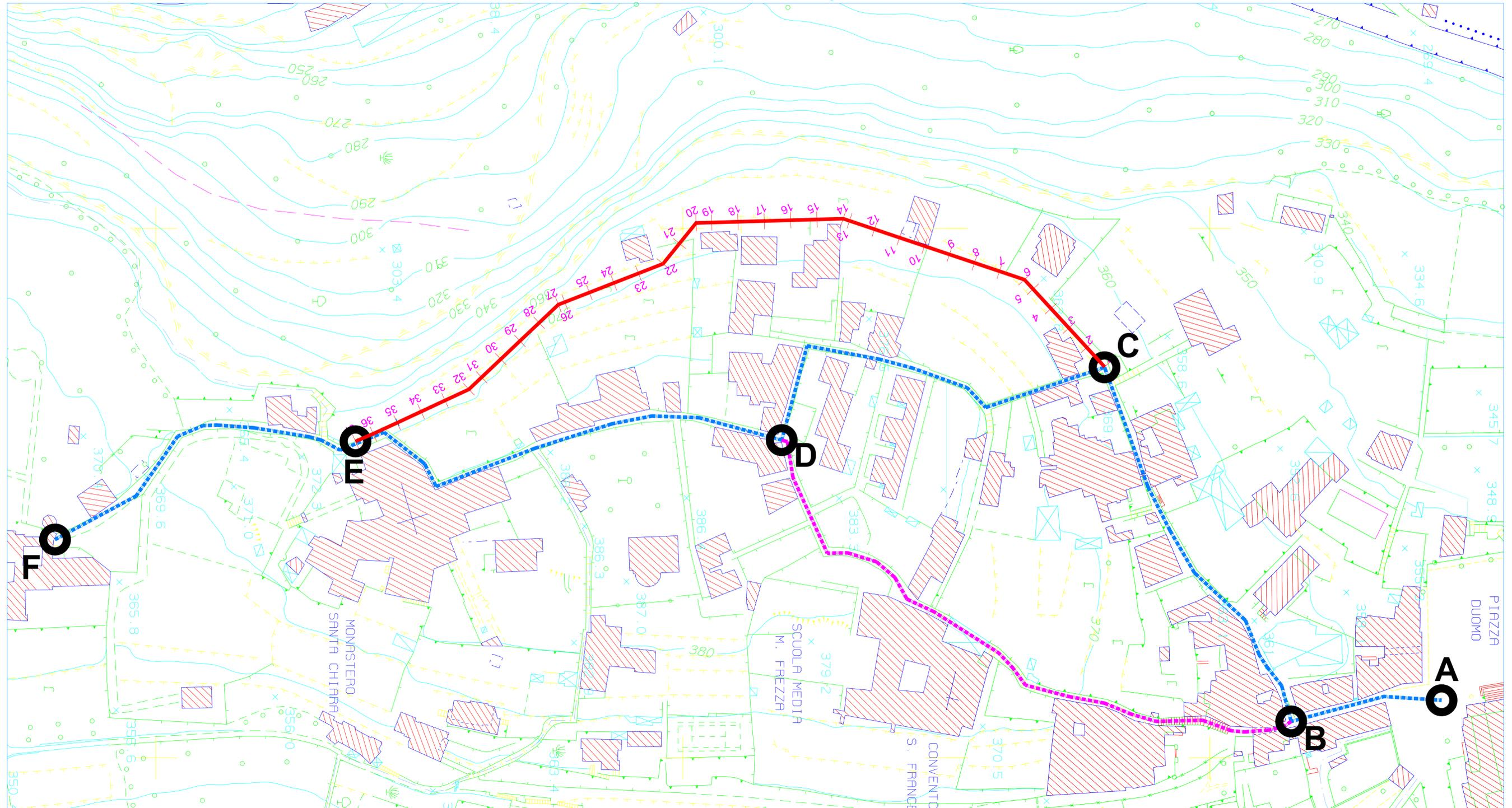
**— Nuovo percorso con Poligonale d'Asse ed individuazione delle sezioni trasversali del nuovo tracciato proposto**
